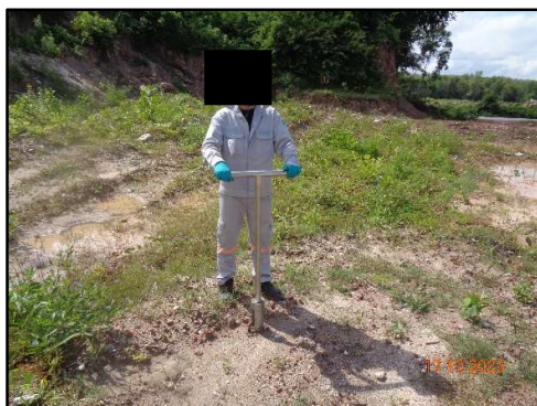
ภาพที่ 3.38 การตรวจวัดตะกอนดินบริเวณ บ่อดักตะกอน 1 (บ1)
